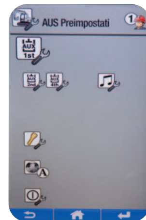
DUE AUX REGOLABILI Le linee Aux proporzionali sono due. La Aux 2 può essere utilizzata per funzioni idrauliche Aux 4 per gestire attacchi rapidi o rotazioni.
