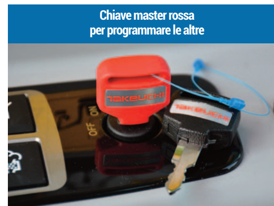
ANTIFURTO Il TB350R si difende dai furti grazie all'immobilizer (ricodificabile) integrato nella chiave d'avviamento.
